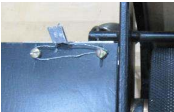
Typical wire and seal method (display housing, cover plate, and cable connection) / Méthode typique de scellage avec fil et scellé (boîtier de l'afficheur, couvercle, et câble)
