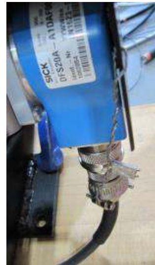
Typical alternate wire and seal methods for display housing and cable connection / Méthodes typiques alternatifs de scellage avec fil et scellé pour le boîtier de l'afficheur et le câble
