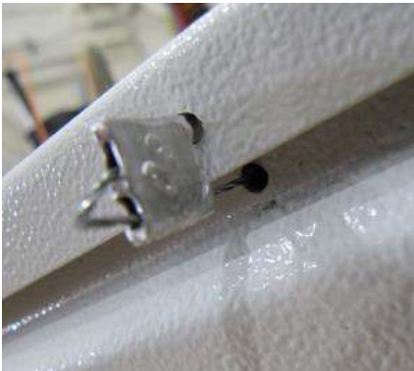
Typical alternate wire and seal methods for display housing and cable connection / Méthodes typiques alternatifs de scellage avec fil et scellé pour le boîtier de l'afficheur et le câble
